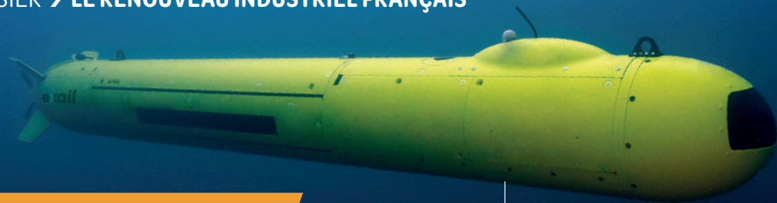
L'A18-D, véhicule sous-marin autonome (AUV) d'Exail destiné à l'étude 3D précise des fonds marins.
